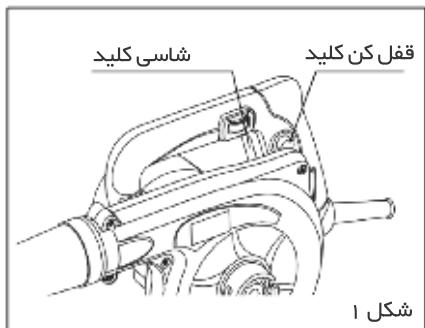
برای روشن کردن دستگاه کلید را فشار دهید و برای خاموش کردن، آن را رها کنید.
