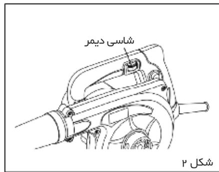
با چرخاندن شاسی دیمر، سرعت دستگاه را می توانید از ۸۳۰۰ تا ۱۶۳۰۰ دور در دقیقه تغییر دهید همچنین این عمل را در زمان روشن بودن دستگاه می توانید انجام دهید. همچنین فشار هوای خروجی می تواند از ۱/۶ تا ۳/۲ متر مکعب بر دقیقه تغییر کند که کاربر می تواند مناسب با کار مورد نیاز آن را تنظیم کند. دیمر این دستگاه ۶ حالت دارد که با اعداد ۱ تا ۶ علامت گذاری شده است. کمترین سرعت در حالت ۱ بدست می آید و بیشترین سرعت در حالت ۶ بدست می آید. (شکل ۲)
