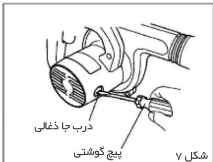
برای باز کردن درب جا ذغالی از پیچ گوشته استفاده نمایید و بعد از تعویض ذغالهای درب جا ذغالی را محکم بینید. (شکل ۷)
